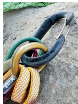
Plastikowy karabinek sprzętowy o wytrzymałości 5 kg. Nie nadaje się do wspinaczki!
