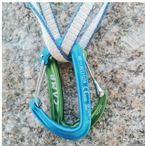
Dwa karabinki zwykłe z zamkami w przeciwnych kierunkach pełnią funkcję (np. na stanowiskach) karabinka z blokadą
