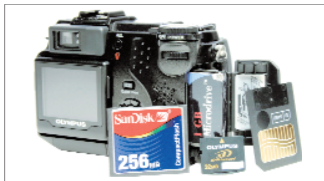
Rysunek 1.6. W Olympusie C-5050 można stosować nośniki czterech typów: CompactFlash (po lewej), xD-PictureCard (w środku), SmartMedia (po prawej) i IBM Microdrive (w aparacie)
