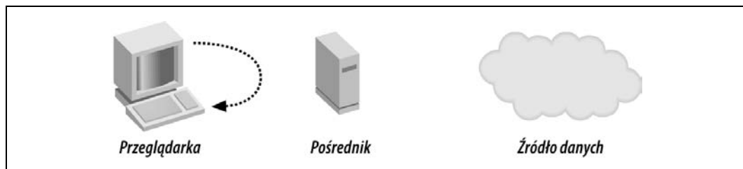
Rysunek 5.4. Jeśli odpowiedź jest zbuforowana w pamięci przeglądarki, żądanie nie zostaje dostarczone do pośrednika, przez co nie powoduje wygenerowania jakiegokolwiek ruchu sieciowego.
