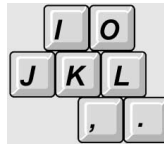
Rysunek 6.61. Zestaw klawiszy J-K-L można uważać za podstawowy w edycji nieliniowej. Korzystając z nich, uzyskujemy szybki dostęp do funkcji sterowania odtwarzaniem i edycyjnych
