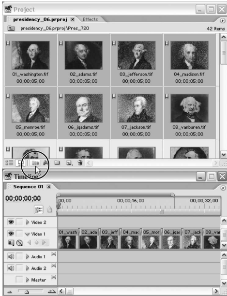
Rysunek 6.3. Układając klipy w oknie Project , możemy tworzyć scenariusze obrazkowe, a za pomocą funkcji Automate to Sequence (przycisk widoczny w kółku) — szybko łączyć je w sekwencje
