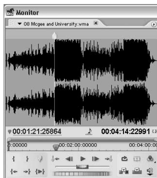
Rysunek 6.13. Podziałka czasowa wyskalowana jest w jednostkach audio, o czym świadczy wskazanie na wyświetlaczu czasu bieżącego oraz ikona nuty
