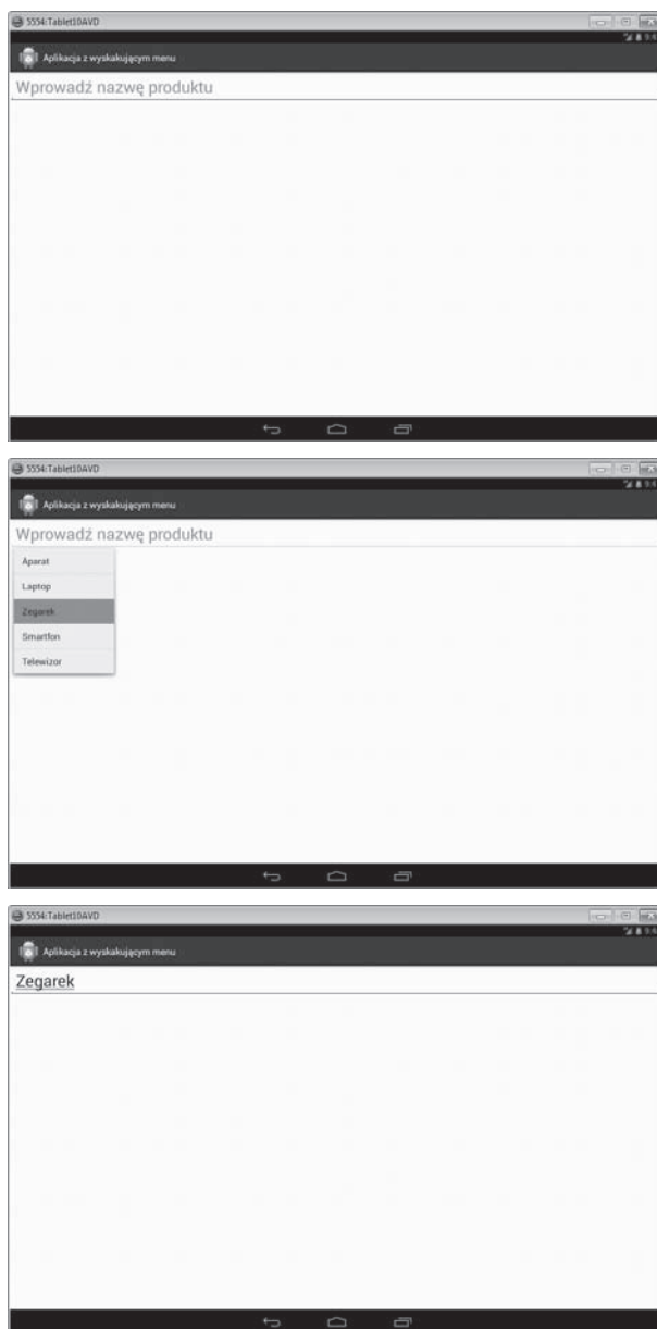
Rysunek 4.7. Kontrolka EditText z prośbą o podanie nazwy produktu (górný obrazek). Pokazujący dostępne opcje widżet PopupMenu, który został wyświetlony po kliknięciu kontrolki EditText (środkowy obrazek). Produkt wybrany z PopupMenu pojawia się w kontrolce EditText (dolny obrazek)
