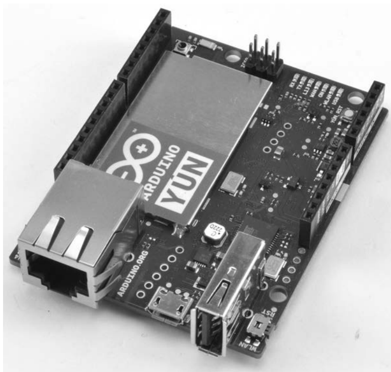
Rysunek 1.7. Płytko Arduino Yun
