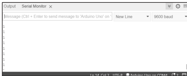
Rysunek 3.6. Arduino prawidłowo interpretuje 5 V jako stan wysoki
