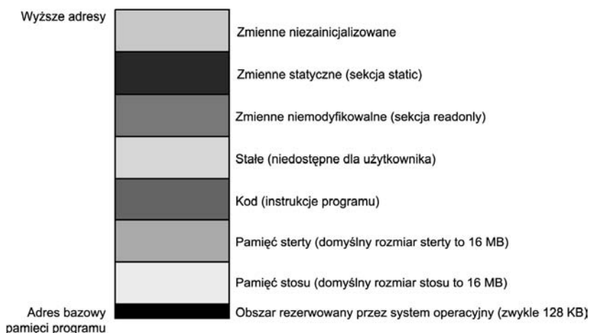
Rysunek 3.7. Typowe rozmieszczenie elementów programu HLA w pamięci
