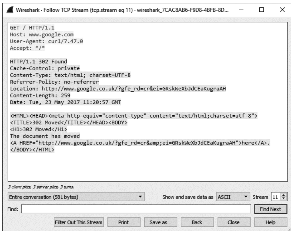
Rysunek 2.3. Czytelna prezentacja strumienia TCP w oknie programu Wireshark
