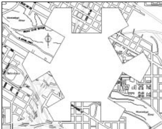
Zasłona o skomplikowanym kształcie utworzona za pomocą polecenia SUPERHATCH
