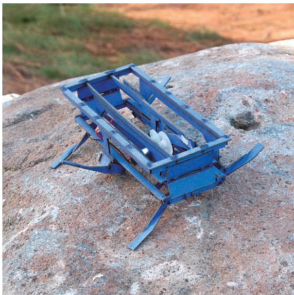
Rysunek 1.4. DASH jest robotem przypominającym insekta; jego konstrukcja została wykonana z kartonowych elementów wycinanych za pomocą lasera Źródło: Dash Robotics
