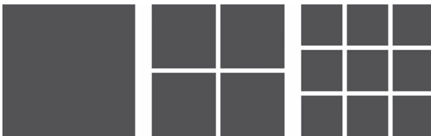
Rysunek 2.3. Piksel CSS na ekranie o rozdzielczości sprzętowej: 1:1 (po lewej), DPR równym 2 (środek) i DPR równym 3 (po prawej)
