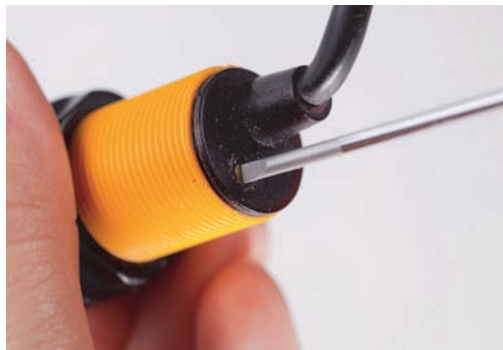
Rysunek 3.8. Regulacja czujnika zbliżeniowego
