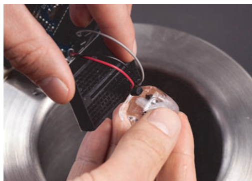
Rysunek 3.19. Testowanie czujnika LM35 za pomocą kostek lodu
