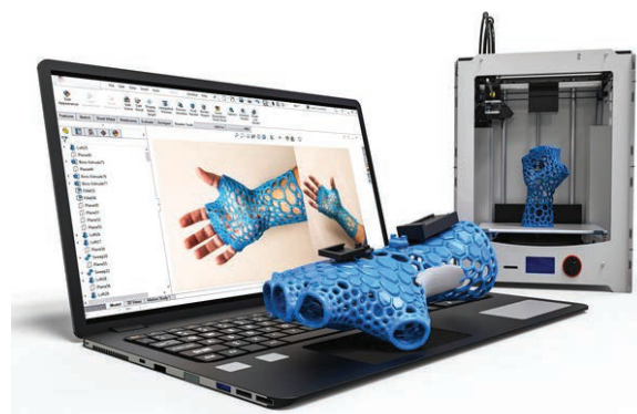
RYSunEK 3.12. Proces tworzenia opatrunku „gipsowego” w przypadku uszkodzenia kości dłoni. Zastosowane zostały techniki skanowania 3D, modelowania CAD i druku 3D
