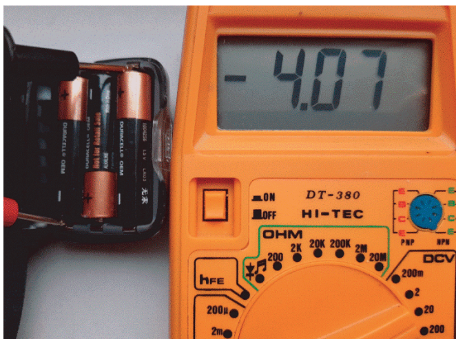
Rysunek 2.4. Sumaryczne napięcie trzech baterii ma wartość 4,07 V
