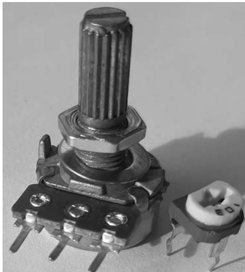
Rysunek 4.8. Potencjometr (z lewej) i potencjometr montażowy (z prawej)
