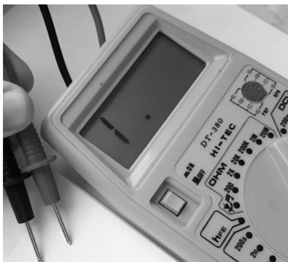
Rysunek 4.1. Tak miernik cyfrowy sygnalizuje, że mierzona wartość jest większa od ustawionego zakresu
