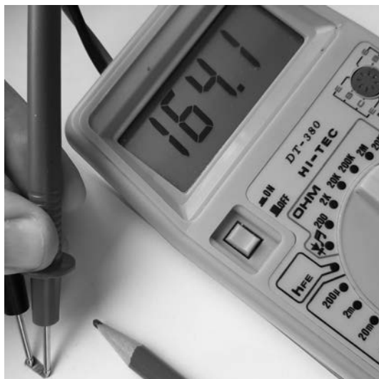
Rysunek 4.2. 164,1 k \Omega . Taką rezystancję ma narysowana kreska. Twoja może mieć inną
