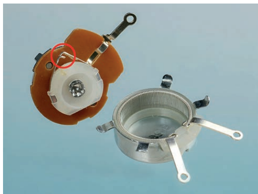
Rysunek 1.46. Zakreślony ślizgacz potencjometru
