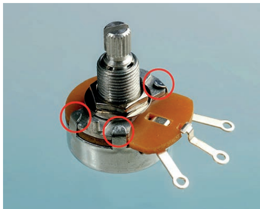
Rysunek 1.44. Zakładki obudowy potencjometru
