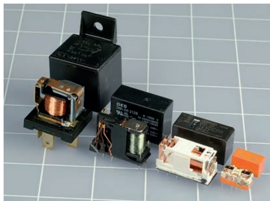
Rysunek 7.12. Przekaźniki różnego typu zasilane napięciem 12 V
