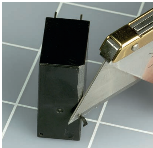
Rysunek 7.8. Zaczynij od odcięcia plastikowych krawędzi obudowy; cięcia wykonuj od góry do dołu (w stronę powierzchni, na której pracujesz)
