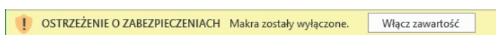
Rysunek 1.3. Przycisk Włącz zawartość widoczny w przypadku użycia opcji Wyłącz wszystkie makra i wyświetl powiadomienie.
