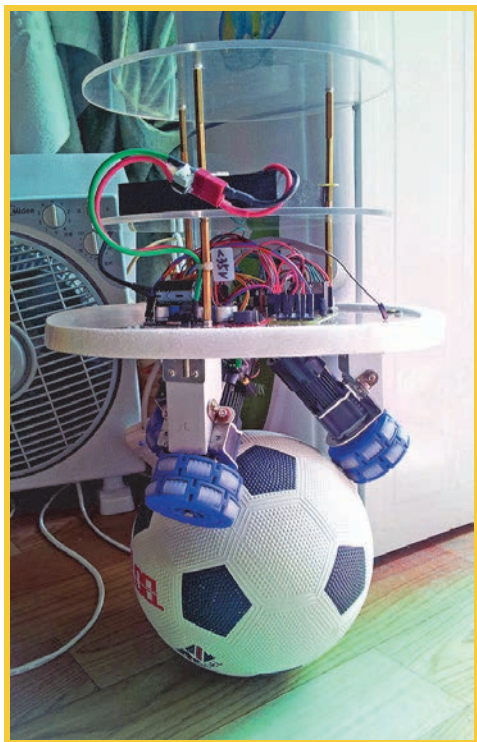
RYSUNEK 2.8. Robot poruszający się na piłce Zdjęcie: uFactory
