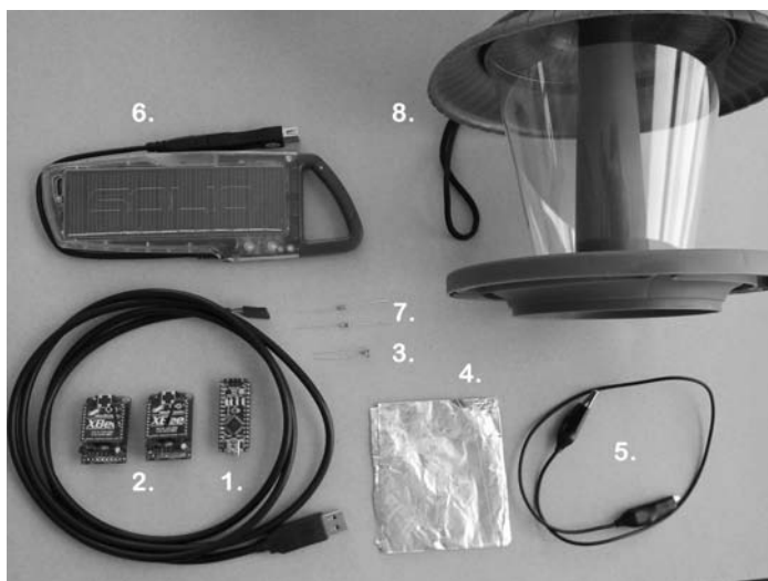
Rysunek 5.2. Części systemu ćwierkającego karmnika dla ptaków
