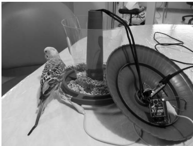
Rysunek 5.7. Papużka może pomóc w testowaniu i diagnozowaniu wartości progowych czujnika grzędy dla zdarzeń lądowania i odlatywania ptaków
