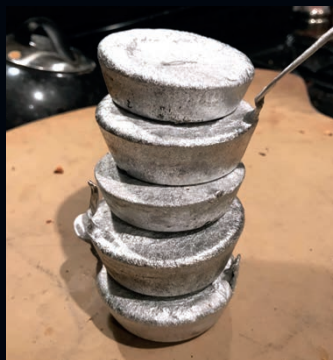
Stos aluminiowych wlewków z puszek po napojach, odlanych w formach do babeczek
