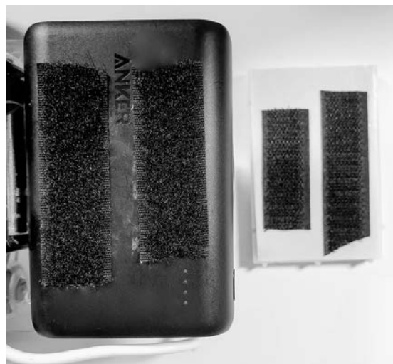
Rysunek 8.12. Przyklejenie rzepów
