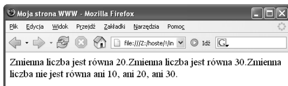
Rysunek 2.5. Wynik pominięcia niezbędnych instrukcji break
