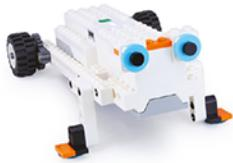
LEGO BOOST to klocki konstrukcyjne, które łączą możliwości standardowych klocków LEGO i nowoczesnej mechaniki. Pozwalają na budowę przeróżnych robotów, wyposażonych w rozmaite czujniki, siłowniki i sterowniki. Dzięki specjalnie zaprojektowanej aplikacji na tablety możliwe jest nie tylko uzyskanie szczegółowych instrukcji, ale również zaprogramowanie zbudowanego modelu. Oczywiście poszczególne roboty można zmieniać, rozwijać, rozbudowywać — co tylko podpowiada Ci wyobraźnia.
