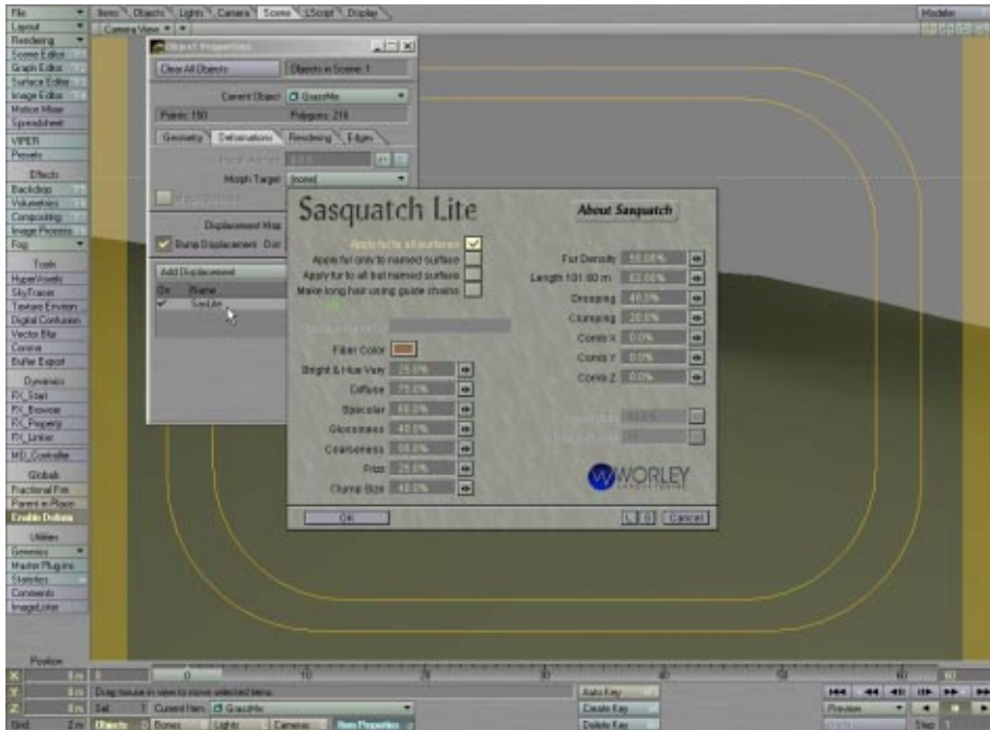
Rysunek 10.27. Okno SasLite Displacement Plug-in zawiera wszystkie opcje odpowiedzialne za wygląd włókien na powierzchni obiektu
