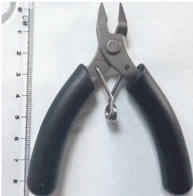
Rysunek 1.6. Cienkie zakończenia ułatwiają precyzyjne operowanie narzędziem
