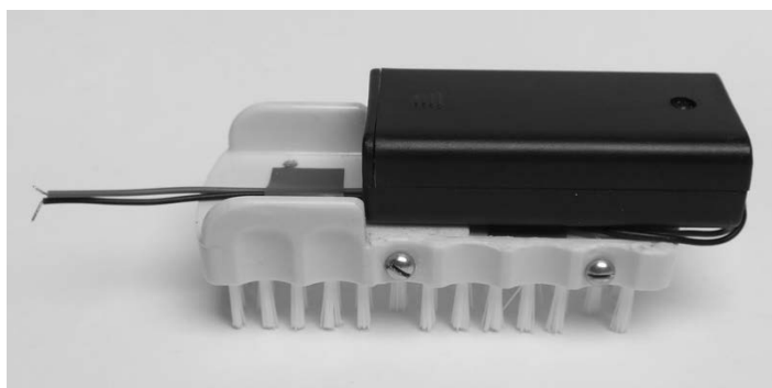
Rysunek 7.5. Montowanie pojemnika na baterie
