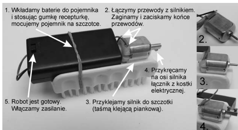
Rysunek 7.2. Budowa robota typu Brush Bot w wersji testowej
