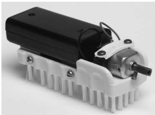
Rysunek 7.7. Zmontowany robot — Szczotkowiec BB-01
