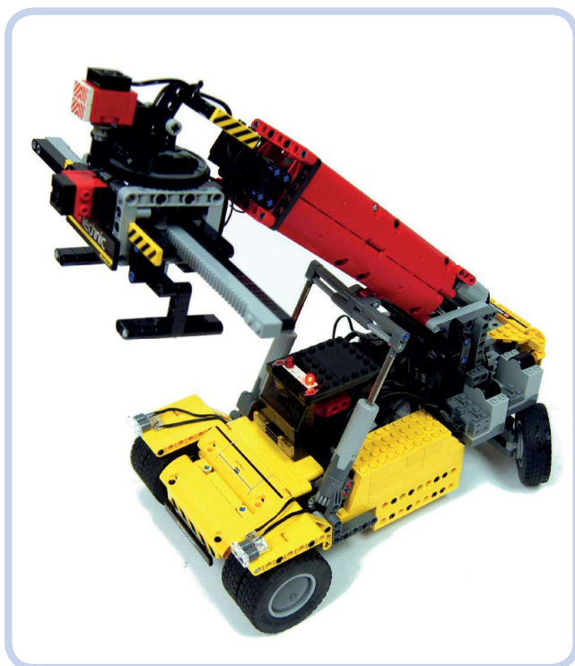
Rysunek 1-5: Mój model podnośnika kontenerowego (reach stacker) ma tylną oś (po prawej) ze szczególnie dużym kątem skrętu, podobnie jak prawdziwy pojazd. Podnośniki te są przeznaczone do ustawiania kontenerów w obszarach załadunkowych portów i muszą manewrować na ograniczonej powierzchni.
