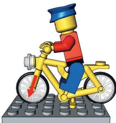
Rysunek 1-10: Typowy rower ma dodatni kąt wyprzedzenia sworznia zwrotnicy w przednim kole. Wynika to z przegięcia widelca względem jego położenia pionowego (czerwona strzałka wskazuje kąt widelca) i poprawia stabilność roweru.
