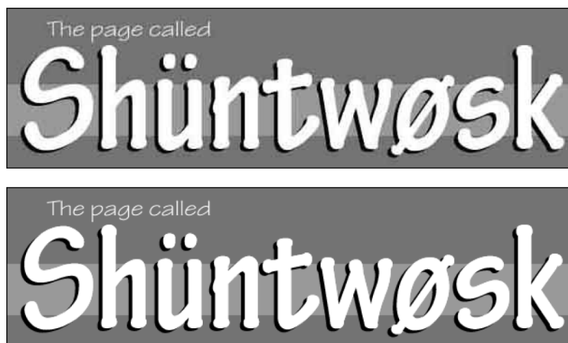
Rysunek 19.5. Format JPEG o dużym stopniu kompresji tworzy dziwaczne wzorki w obrazku o dużym kontraście (u góry). Dla porównania, format GIF zachowuje pierwotną ostrość obrazka przy porównywalnej wielkości pliku (u dołu)
