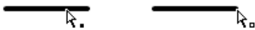
Rys. 3.39. Gdy obok kursora pojawi się pełny kwadracik, możesz zaznaczyć całą ścieżkę (po lewej). Pusty kwadracik wskazuje, że możesz zaznaczyć i modyfikować pojedynczy punkt kontrolny (po prawej)
