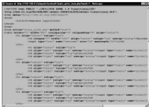
Rysunek 1.8. Rozważne wykorzystywanie instrukcji echo oraz spacji w skryptach PHP powoduje, że kod źródłowy HTML staje się bardziej czytelny
