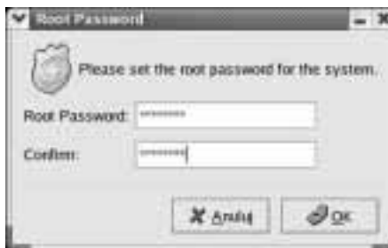
Rysunek 6.24. Jeśli chcesz zmienić hasło administratora systemu, wybierz z menu System Settings pozycję Root Password
