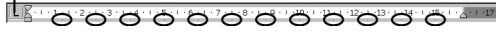
Rysunek 3.36. Położenie domyślnych znaków tabulacji jest na linijce zaznaczone niewielkimi szarymi, pionowymi kreskami
