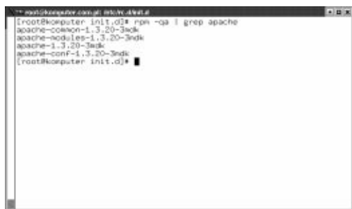
Rysunek 4.4. Pakiety serwera Apache w wersji 1.3.20, zainstalowane przy użyciu polecenia rpm — widok z konsoli tekstowej
