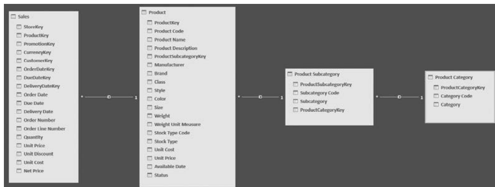
RYSUNEK 1.15. Tabele Product Category, Product Subcategory i Product są powiązane łańcuchem relacji i tworzą schemat płatka śniegu
