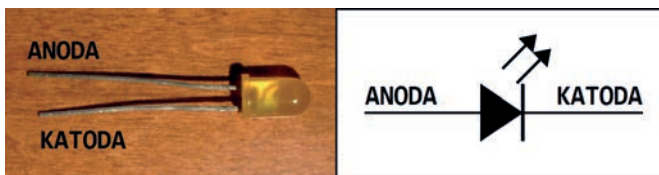
Rysunek 2.23. Oznaczenie nóżek diody LED rzeczywistego komponentu (z lewej) i symbolu stosowanego w schematach (z prawej)
