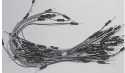
RYСУNEK 3.3. Wysokiej jakości przewody do płytki prototypowej
