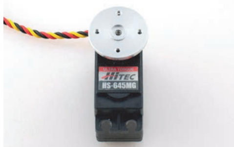
Rysunek 5.5. Serwowmotor ustawiony w pozycji 90° z poprawnie założoną nasadką
