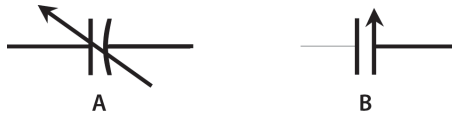
Rysunek 3.13. Alternatywne symbole kondensatorów nastawnych; na symbolu A łuk symbolizuje rotor, a linia prosta stator, zaś na symbolu B rotor jest oznaczony linią zakończoną strzałką
