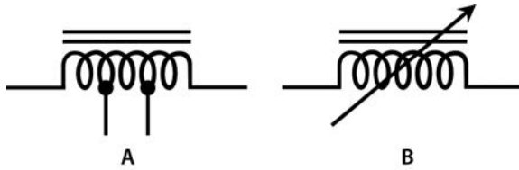
Rysunek 3.21. Symbole cewek o rdzeniu wykonanym z żelaza, które posiadają odczepy (A) lub są regulowane (B)
