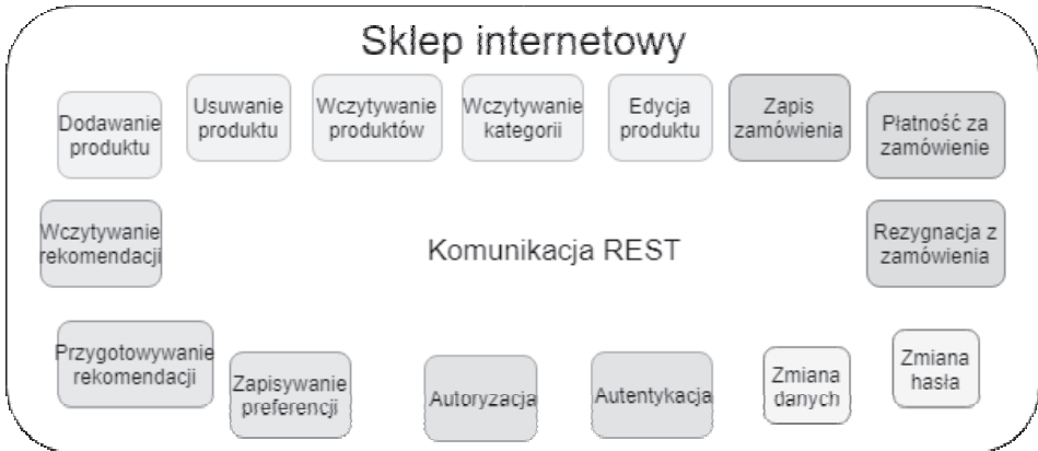
RYСУNEK 1.3. Przykład architektury opartej na funkcjach — każda funkcjonalność sklepu internetowego wydzielona jako osobna funkcja
