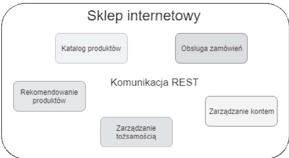
RYСУNEK 1.2. Przykład architektury mikroserwisów — każda domena sklepu internetowego wydzielona jako osobny mikroserwis
