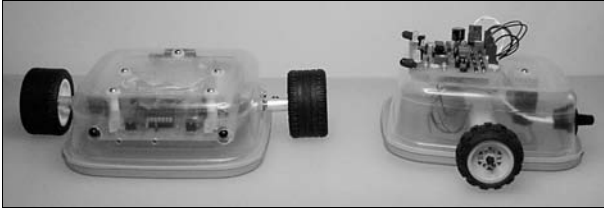
Rysunek 1.2. Płytką z układami robota Rondo zainstalowaną wewnątrz robota Kanapka (po lewej stronie). Możesz użyć tych samych przełączników, złączy, baterii oraz obudowy, montując płytkę z układami robota Rondo na górze obudowy
