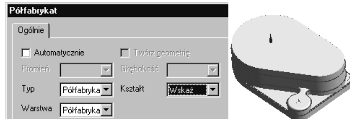
Rysunek 3.17. Okno z parametrami definiowania półfabrykatu i wczytany półfabrykat
